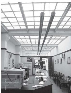
(左)ホールのガラスブロックの床。柱被覆と暖房給気筒はアルミ板加工
